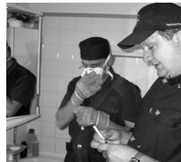
Oben: Blick mit der Videokamera in den Lüftungsschacht. Mitte rechts: Auf dem Monitor ist zu sehen: überall dicke Ablagerungen. Mitte links: Vorbereitung zum Abzugstest mit einer kleinen Rauchgaspatrone. Unten links: Eine Kelle voll Ablagerungen, idealer Nährboden für Schimmelpilze. Unten rechts: Überraschung auf dem Dach. Im Abzugsschacht ist eine TV-Antenne samt Verteilerdose verlegt worden.
